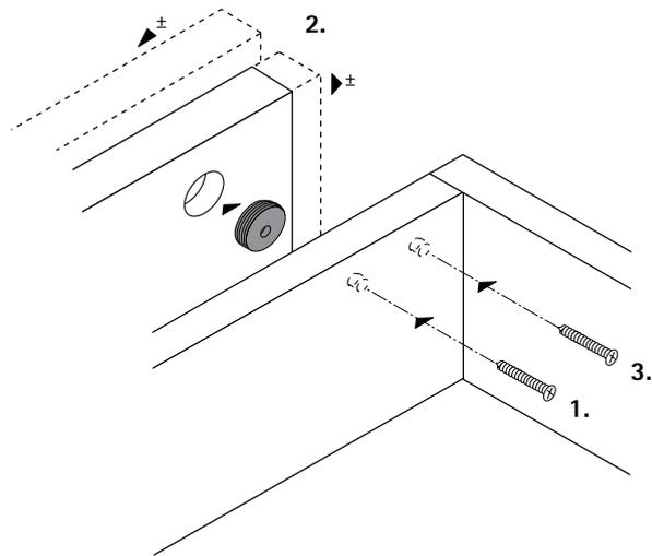
Für den Frontversteller sind Spanplattenschrauben  $\varnothing$  4 mm zu verwenden.
